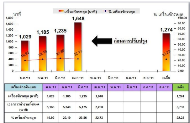
รูปที่ 1 แสดงแนวโน้มที่สูงขึ้นของเวลาที่เครื่องจักรหยุดของเครื่องจักรต้นแบบ (ก่อนการปรับปรุง)
